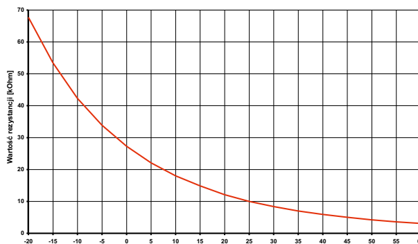
Rys. 7.2: Charakterystyka czujnika NTC-10
